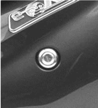
Pour ouvrir le siège, placez le véhicule sur la béquille latérale ou la béquille centrale. Insérez ensuite la clé dans la serrure du siège, située sur le côté gauche. Tournez la clé vers la gauche, pour ouvrir le siège.
