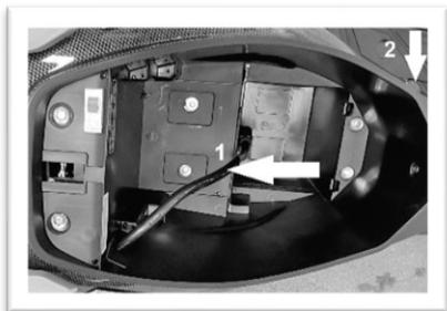
La prise de chargement (1) est située à l'intérieur du coffre à bagages et la prise de chargement (2) est située à l'extérieur du coffre à bagages. Le câble de chargement est directement connecté à la batterie (principale ou en option).
