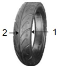
Vérifiez l'indicateur d'usure de la bande de roulement (1) qui est un triangle imprimé sur le côté du pneu. Il pointe vers une ligne de caoutchouc qui est intégrée au pneu et qui traverse la bande de roulement (2). Si vous remarquez que cette ligne se trouve au même niveau que le haut des rainures de la bande de roulement, vous devrez remplacer le pneu.
