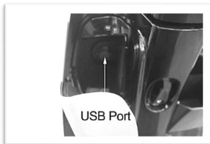
Le port USB se trouve dans la boîte à gants gauche. Il fournit une sortie 5 V-2 A pour recharger votre téléphone ou d'autres appareils électroniques.
